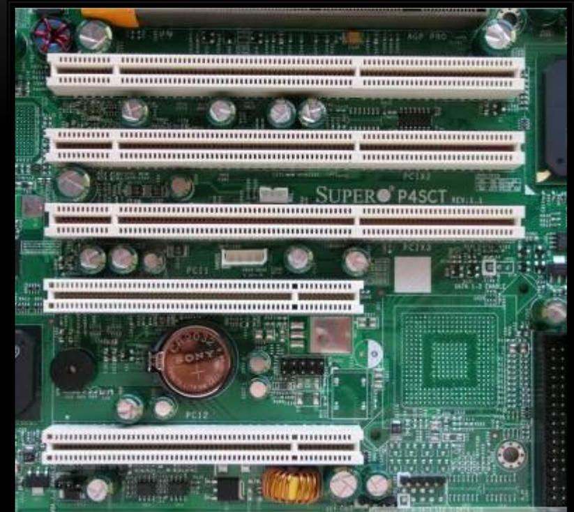
ranuras PCI de 33 MHz 3.3V y 5V. Los slots PCI de 33 MHz
