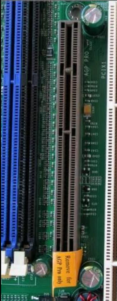
Las ranuras AGP proveen un puerto de alta velocidad que sólo transporta información gráfica e incorpora otras funciones para el manejo de gráficas 3D y texturas. Este puerto está conectado directamente al microprocesador y la memoria a través del bus a una frecuencia más alta que los demás dispositivos, cabe señalar que este tipo de ranura de expansión sólo se encuentra disponible para las tarjetas de video.
